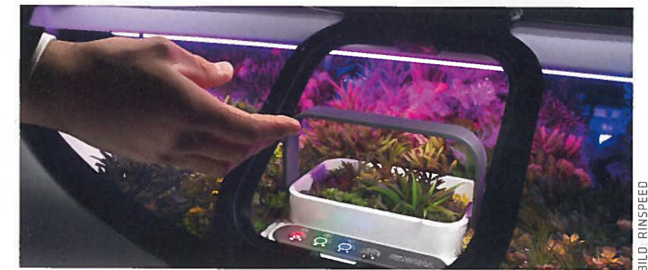
Die Gartenanlage samt automatischer Bewässerung und LED-Beleuchtung stammt von Kostal.
