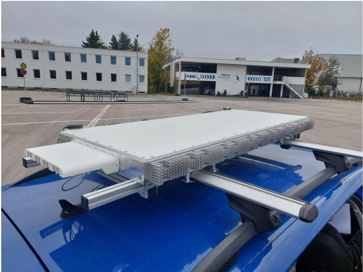
Mit dem neuen Satcom-Terminal von VITES ist auch das Senden und Empfangen während der Fahrt möglich. (Bild: lah)
